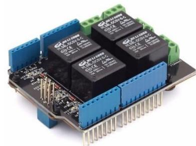
Un relais est un organe électrique permettant la commutation de liaisons électriques. Il est chargé de transmettre un ordre depuis la partie opérative à la partie puissance d'un appareil électrique. Utile pour effectuer une commande de puissance de type tout ou rien, il nous a permis de transformer les 5 V de notre carte Arduino en 12 V pour nos Leds.
